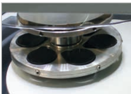
Zentralandruck erfordert nivellierte Proben
