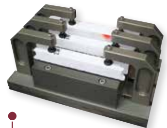
Spannvorrichtung zur Prüfkörperherstellung aus gewölbten Keramikkörpern
