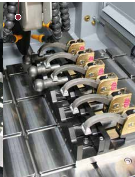
Sistema di bloccaggio per tagli in serie di teste a sfera
