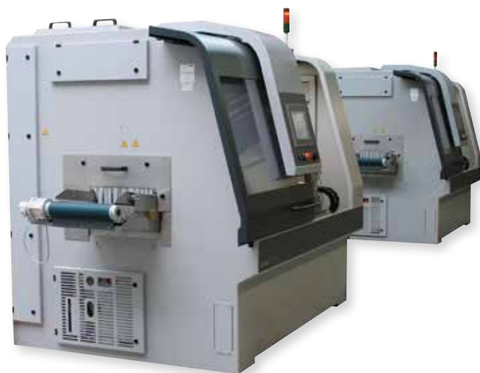
Brillant 250 con speciale asse Z per taglio punte di perforazione
