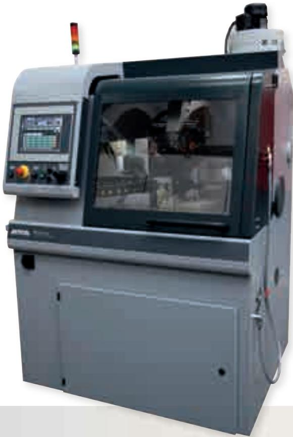
Der 5-Achsen-Trenroboter BRILLANT 3D verfügt über 2 zusätzliche Achsen (D-, E-Achse). Dadurch kann der Prüfling in nur einem Arbeitsgang automatisch in fast jede beliebige Lage zur Trennscheibe positioniert und dann getrennt werden.
