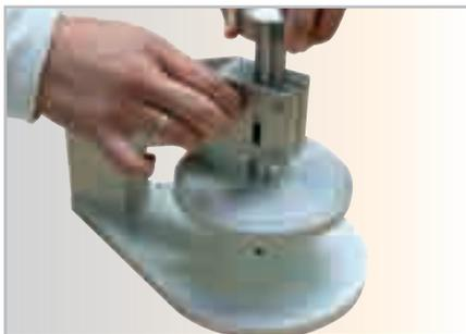
Proben für Härteprüfung ausrichten
