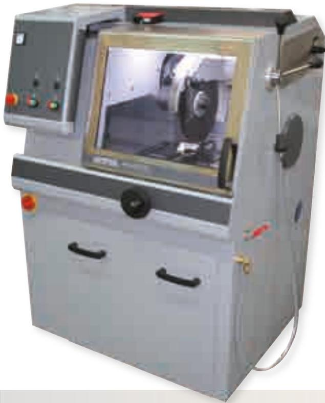
Die Universal-Nasstrennschleifmaschine BRILLANT 255 mit manuellem Fahr- und feindynamischem Kappschnitt erlaubt exaktes, berührungsarmes Trennen mit zwei Achsen in beliebiger Richtung (Y/X-Achse) und kann mit einer manuellen Z-Achse für parallele Serienschritte erweitert werden. Seitliche Durchgänge erlauben auch die Zuführung langer Teile in den großen Trennraum der robusten, pulverbeschichteten Aluminiumkonstruktion.
