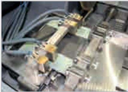
**TAKT-SPANNVORRICHTUNG FÜR BRILLANT 255/265**
