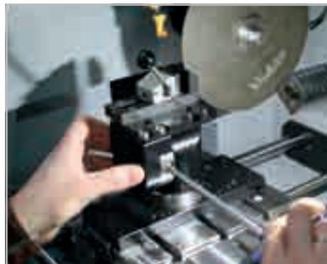
Flexibel durch Dreh- und Spannmodule
