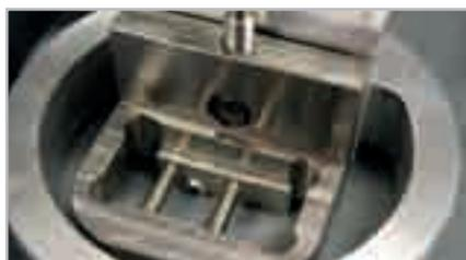
Verwendung mit Duo-Probenhalter aus dem Easy-Spannsystem
