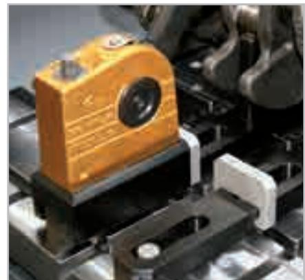
Schiene mit Schlitten und Auflageprisma
